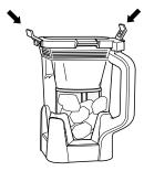
**5** Placez le pichet sur le bloc. Alignez la flèche située sur le pichet avec celle du bloc. Puis, faites tourner le pichet dans le sens horaire jusqu'à ce que vous entendiez un déclic vous indiquant qu'il est bien en place.
