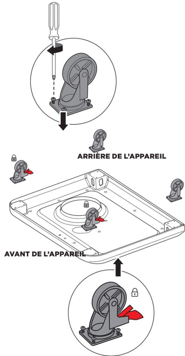
**IMPORTANT :** Les roulettes verrouillables doivent être montées sur le côté avant aux coins arrondis.
