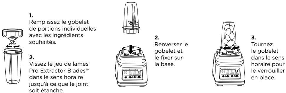
Une fois le gobelet de portions individuelles verrouillé en place, appuyez sur le bouton Power (mise en marche) pour mettre l'appareil en marche. Les boutons des programmes compatibles s'allumeront.
