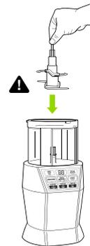
**4** En tenant le jeu de lames quadruple par le haut de la tige avec soin, placez-le sur à l'intérieur du bol.
