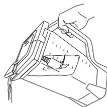
**⚠ AVERTISSEMENT :** Le jeu de lames superposées est tranchant et n'est pas verrouillé dans le récipient. Pour verser sans le couvercle, retirez d'abord le jeu de lames superposées avec précaution en le tenant par le manche. Ne pas procéder de la sorte augmente le risque de lacération.
