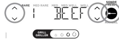
**REMARQUE :** Pour utiliser la fonction MANUAL (manuel), sélectionnez de nouveau le bouton du thermomètre. Utilisez les températures de cuisson internes recommandées dans le guide de l'utilisateur.
