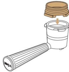
Placez l'entonnoir sur le porte-filtre avec le panier double\*, en alignant les encoches de l'entonnoir et celles du porte-filtre. Poussez vers le bas jusqu'à ce que l'entonnoir s'enclenche dans le porte-filtre.
