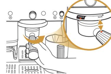
Fixez le porte-filtre dans la tête du groupe jusqu'à ce que le point orange de porte-filtre soit aligné avec la flèche de verrouillage de la tête du groupe.
