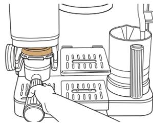
Placez l'entonnoir sur le dessus du porte-filtre et insérez le porte-filtre dans le support de mouture. Assurez-vous qu'il est à niveau et qu'il tient bien en place. Une fois le porte-filtre installé dans le support de mouture, il sera pesé. **Pour garantir un poids précis, ne touchez pas au porte-filtre.**
