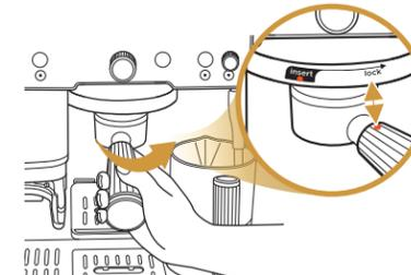
Fixez le porte-filtre dans la tête du groupe jusqu'à ce que le point orange du porte-filtre soit aligné avec la flèche de verrouillage de la tête du groupe.
