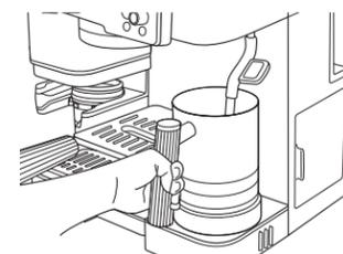
Placez le pichet sur la plateforme du pichet à lait avec la buse à vapeur insérée dans le lait.
