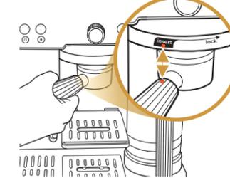
Placez le porte-filtre dans la tête du groupe (à angle vers la gauche) en alignant le point orange sur le porte-filtre avec le point orange sur la tête du groupe.
