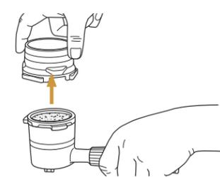
Retirez l'entonnoir du porte-filtre. Rangez l'entonnoir et le presse-café du côté gauche de l'appareil.
