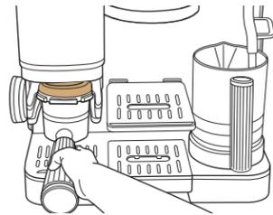
Placez l'entonnoir sur le dessus du porte-filtre et insérez le porte-filtre dans le support de mouture. Assurez-vous qu'il est à niveau et qu'il tient bien en place. Une fois le porte-filtre installé dans le support de mouture, il sera pesé. **Pour garantir un poids précis, ne touchez pas au porte-filtre.**
