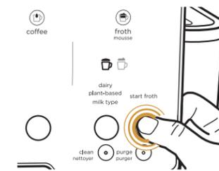
Appuyez sur **START FROTH** (démarrer le moussage) pour commencer à mousser le lait. L'appareil émet un signal sonore pour indiquer que le moussage a commencé. La barre de progression s'allumera pour indiquer l'état du moussage.
