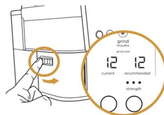
S'ils ne sont pas identiques, **ajustez la mouture en faisant tourner le cadran sur le côté gauche de l'appareil** jusqu'à ce que le chiffre corresponde à la mouture recommandée.
