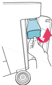
Ouvrez la porte d'accès au CO<sub>2</sub> (retirez la notice d'utilisation si elle n'est pas nécessaire) et tirez le support de CO<sub>2</sub>.
