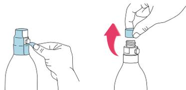
Retirez le témoin d'intégrité et le bouchon de plastique de la bouteille de CO<sub>2</sub>.
