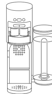
Fermez le chariot à saveurs. Un signal sonore d'erreur est émis si le chariot à saveurs n'est pas complètement fermé.
