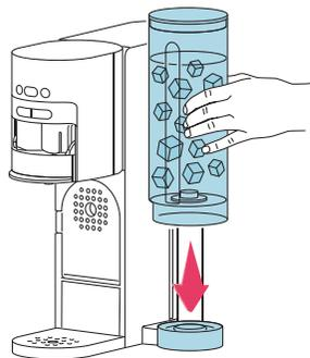
Placez le réservoir d'eau rempli sur la station de recharge.
