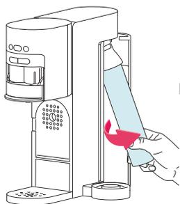
Installez la bouteille dans le support en la tournant vers la droite. **TOURNEZ JUSQU'À CE QUE LA BOUTEILLE SOIT BIEN SERRÉE AU SUPPORT.**
